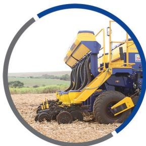
**Linha de semente pantográfica:** garante o acompanhamento das variações de topografia do solo, permitindo uma deposição de sementes sempre na profundidade correta.
