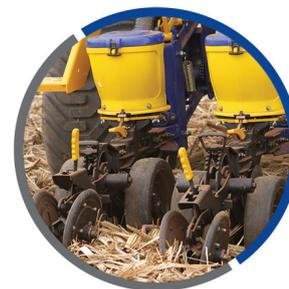
**Sistema de Controle de profundidade:** o controle da profundidade é responsável pela uniformidade da emergência do plantio. A TATU oferece a maior linha de controles de profundidade do mercado.
